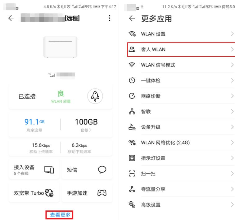
5. 点击“客人 WLAN”右侧的按钮开启该功能，设置“客人 WLAN”的“WLAN 名称”、“密码”及“开启时长”。点击“确定”成功创建“客人 WLAN”，客人可以将无线上网设备连接到此客人 WLAN 上网。
