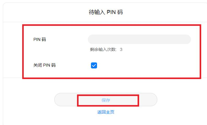
2. 在“PIN 码”输入框中输入正确的 PIN 码，点击“保存”，即可通过 PIN 码验证。
