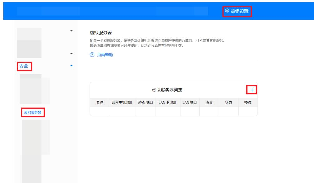
3. 在“名称”中输入自定义的服务名称。在“协议”中选择服务采用的协议类型。在“远程主机地址”中输入远程需要访问该服务的计算机的 WAN IP 地址。在“WAN 端口”中输入 CPE 供因特网用户访问的服务端口号。在“设备”中选择需要提供服务的计算机（如 Web 服务器、FTP 服务器等）。在“LAN IP 地址”中输入对外提供服务的计算机的 IP 地址。在“LAN 端口”中输入对外提供服务的计算机的服务端口号。点击“确定”。
